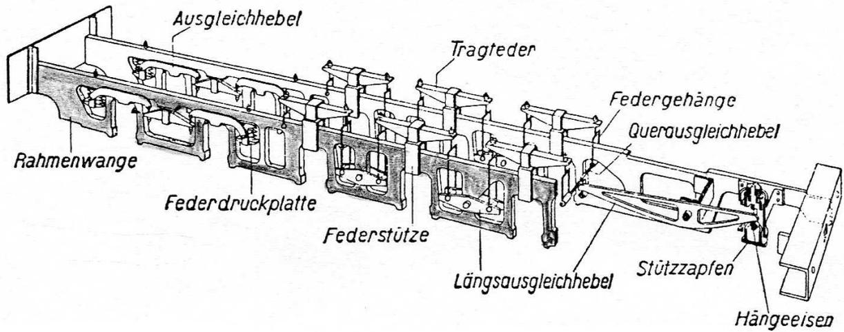
Abb. 6 - 1 Barrenrahmen / Lastausgleich (Niedersträßer 1979)
